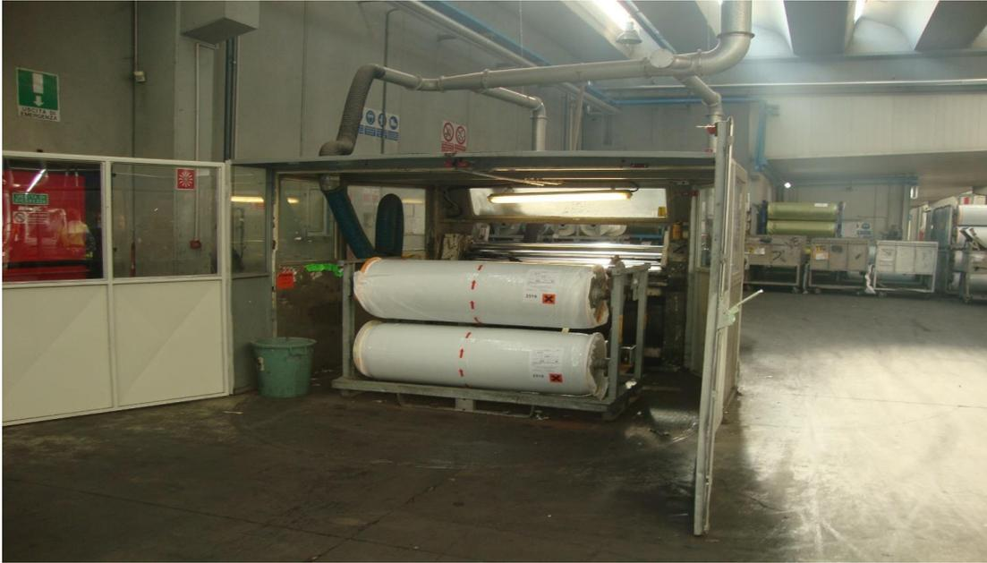
Lo stesso carrellista oppure il responsabile del taglio, provvedono a servire le singole presse con i quantitativi e le pezzature opportune di materia prima necessaria alla produzione attraverso l'ausilio di carrelli numerati (movimentati meccanicamente) che facilitano il trasporto della materia stessa.
