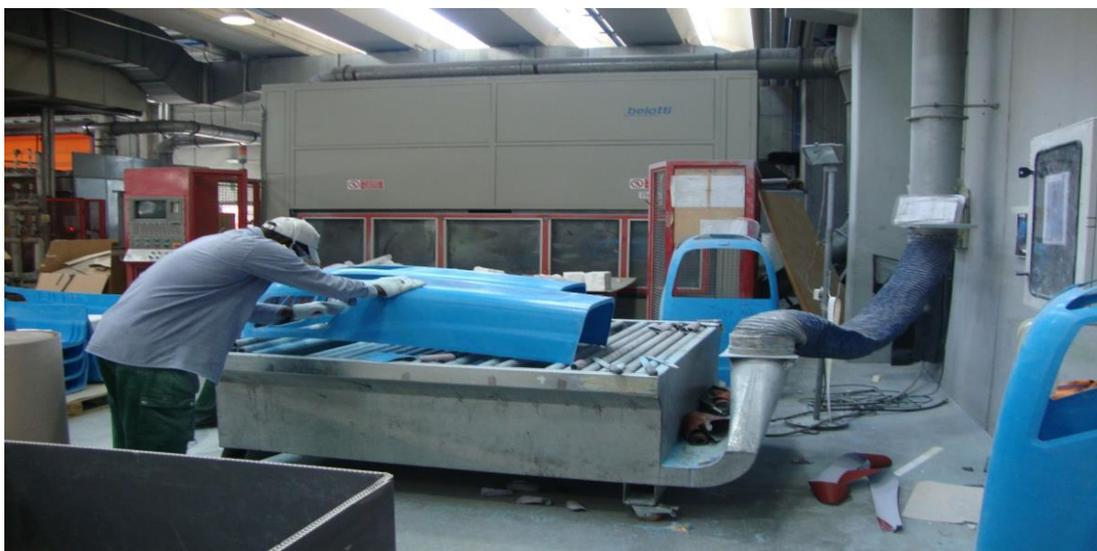
L'operazione di eliminazione delle sbavature delle parti terminali del pezzo avviene tramite cutter, mentre la carteggiatura elimina le imperfezioni superficiali del pezzo e avviene tramite l'uso di fogli di cartavetra.
