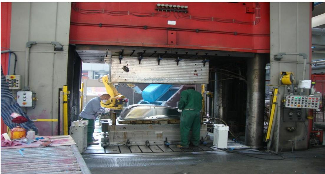
Nel reparto produttivo sono presenti n°10 presse verticali di varia portata, di cui n°4 dotate di sistema robotizzato di scarico del pezzo realizzato; a servizio delle altre presse opera un addetto o n°2 addetti a seconda delle dimensioni dei pezzi realizzati e da scaricare.
