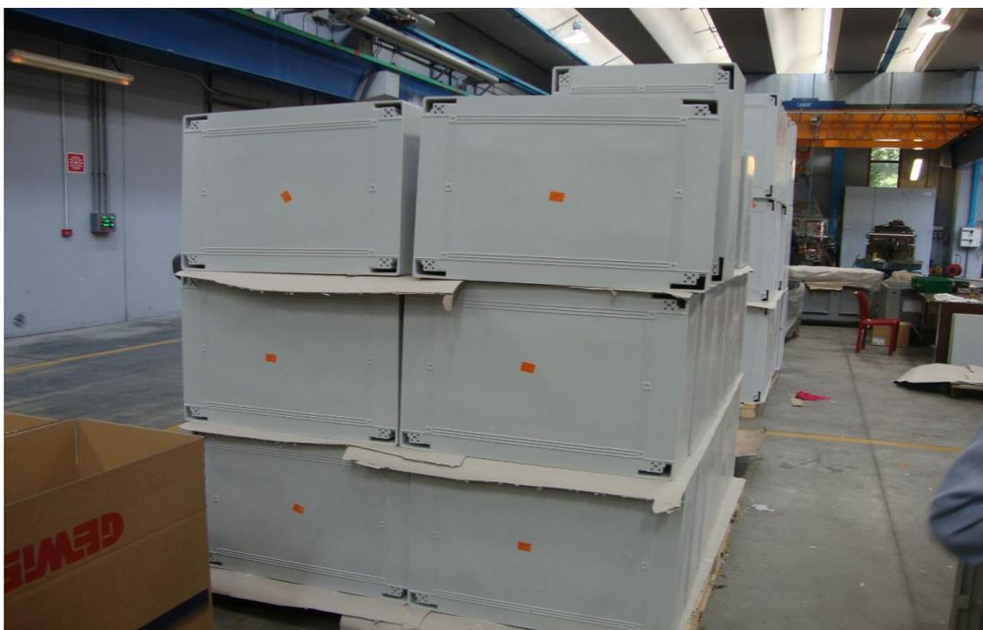
Durante l'assemblaggio le operazioni di insertaggio possono essere effettuate in automatico solo per le casse Gewiss di piccole dimensioni, invece per le casse Gewiss di dimensioni maggiori questa fase viene effettuata manualmente con l'utilizzo di un martello.
