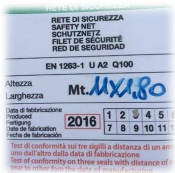
La normativa tecnica prevede oltre a verifiche visive, anche test di trazione da realizzarsi su maglie di prova per il mantenimento in esercizio della rete. Tali maglie, appositamente fissate alla rete, sono sottoposte – con periodicità stabilita nelle istruzioni – a prova da parte del fabbricante o da parte di un soggetto autorizzato da quest'ultimo.
