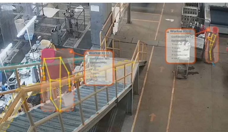
Figura 3 – rilevazione del comportamento di discesa da una scala tenendosi al corrimano - con il permesso del produttore.
