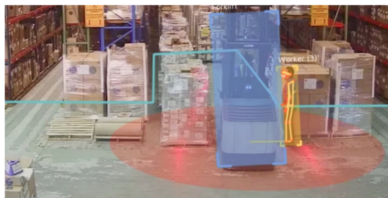
Figura 4 – regola della delimitazione d'area dinamica in azione, mostra la rilevazione di un rischio derivante da una persona troppo vicina ad un carrello in movimento - con il permesso del produttore.
