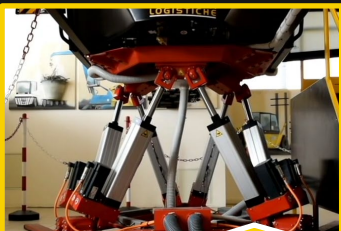
Una piattaforma stewart che simula i movimenti reali di un forklift
