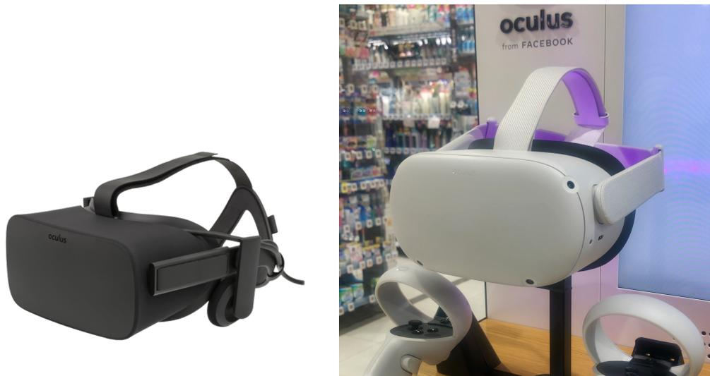
**Figura 1.2:** *A sinistra Oculus Rift, che per essere utilizzato dev'essere collegato ad un PC il quale si occuperà dell'elaborazione dell'applicazione. A destra invece Oculus Quest 2, dispositivo stand-alone, che può essere utilizzato in maniera indipendente senza un PC.*
