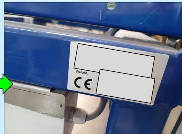
Anche il macchinario aggiunto è marcato CE, ma la modifica non altera il layout della rete di protezione, né le caratteristiche di sicurezza dei dispositivi in dotazione (es. interblocchi). Non occorre alcuna nuova CE di insieme, ma unicamente una valutazione dei rischi all'interfaccia tra la nuova macchina e le pre-esistenti.
