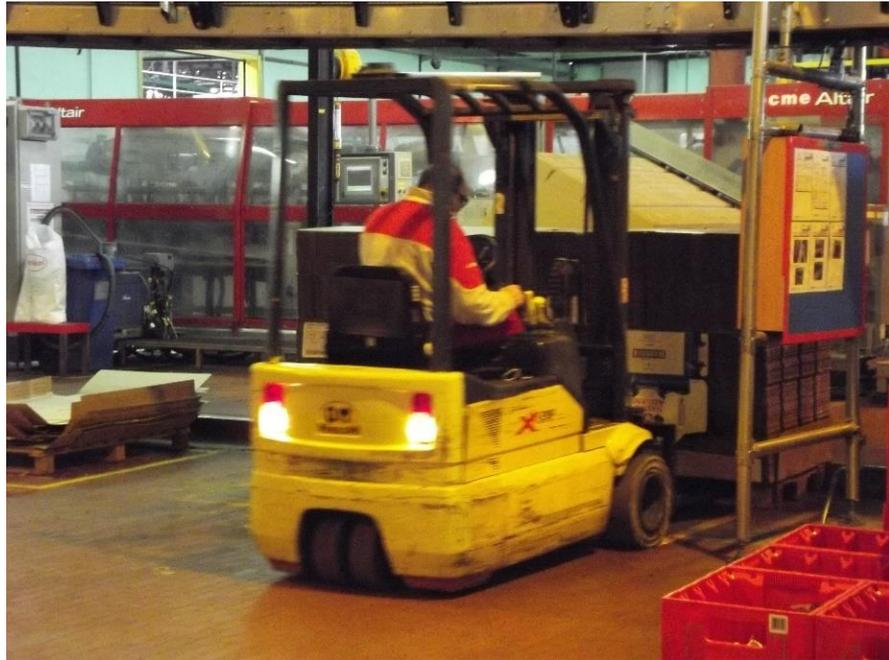
*Figura 36 : Fase di approvvigionamento materiale attraverso l'utilizzo di un carrello elevatore a forche frontali*
