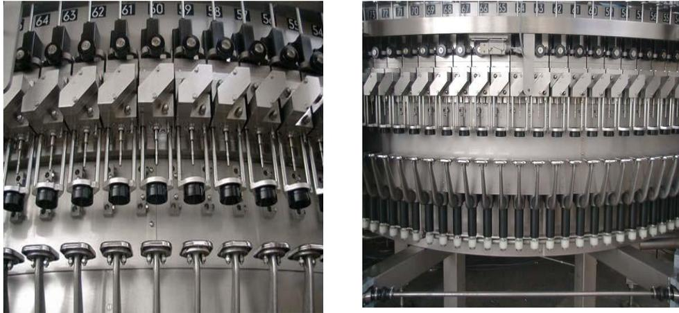
Figura 5 : Particolari della riempitrice della linea 2 dello stabilimento di Roma(Fonte: Peroni Academy (2005) "Conoscere il nostro processo produttivo").
