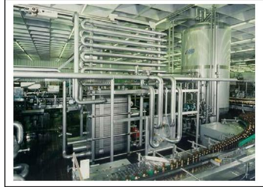
Figura 6 : Diverse tipologie di pastorizzatori(Fonte: Peroni Academy (2005) “Conoscere il nostro processo produttivo”).
