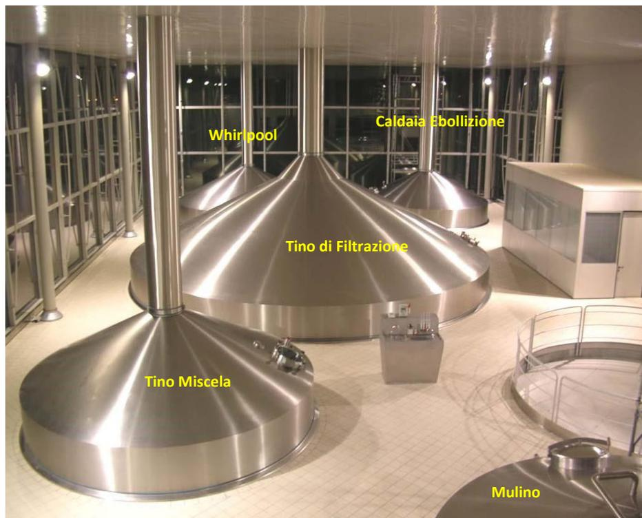
*Figura 2 : La nuova sala di cottura di Bari (anno 2004)*
