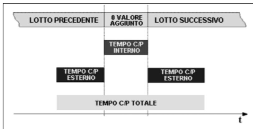
Figura 15 : Tempi di setup interno ed esterno((Fonte: adattato da Shingo, 1985)
