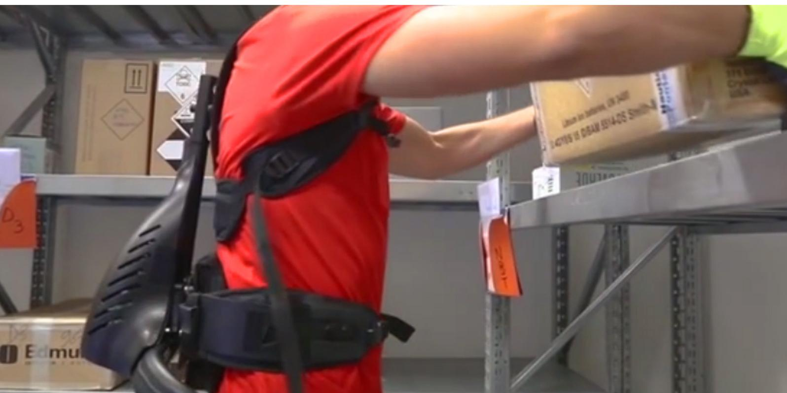
dell'attività. L'esoscheletro è costituito da diversi moduli, che potranno essere usati in configurazioni diverse a seconda della specifica applicazione. I moduli supportano rispettivamente tronco e braccia. Lo scopo del modulo del tronco è la riduzione dei carichi nella zona lombare dell'operatore.
